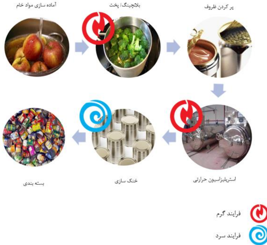
شکل ۱۶. نمای شماتیک فرآیند تولید در صنعت تولید کنسرو میوه و سبزیجات
